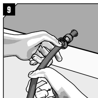
Wenn bereits ein Kabel durch einen Durchbruch von  $\varnothing 15,5\text{mm}$  verlegt wurde, kann die B15-SPC Durchführung durch das Öffnen der inneren Kerbe geteilt und seitlich über das Kabel montiert werden.
