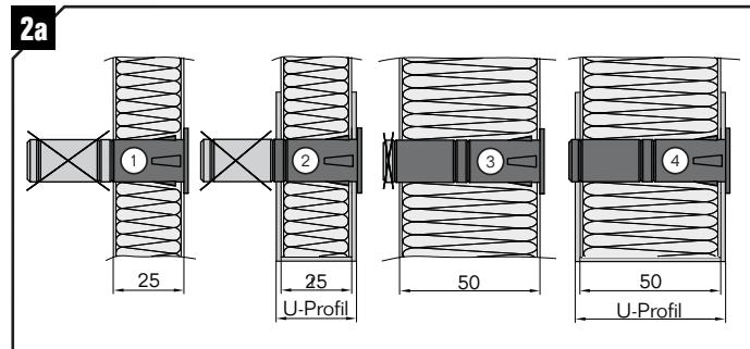
Für Kabeldurchführung B15-SPC senkrechtes Loch mit Durchmesser 15,5mm herstellen, ggf. Schnittgrat entfernen.
