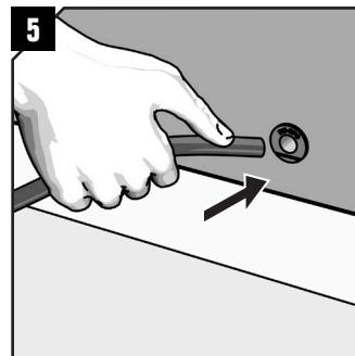
Um Rauchgasdichtigkeit zu gewährleisten, verfügt die B15-SPC Kabeldurchführung im Inneren über eine Membrane, die zur vereinfachten Kabelmontage mit geeignetem Werkzeug vor dem Kabelzug durchstoßen wird. Dieses kann in der Trennfläche (4a) oder vor der Montage (4b) erfolgen.
