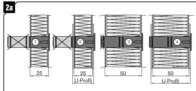
Anpassung der Länge des B15-SPC (Bild 2) entsprechend der Darstellung in Bild 2a vornehmen. Die Montage der Kabeldurchführung erfolgt in Wand, mit oder ohne U-Profil.
