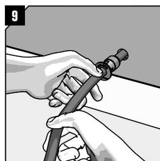
Wenn bereits ein Kabel durch einen Durchbruch von Ø15,5 mm verlegt wurde, kann die B15-SPC Durchführung durch das Öffnen der inneren Kerbe geteilt und seitlich über das Kabel montiert werden.
