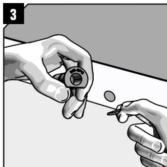
Die B15-SPC Kabeldurchführung verfügt über einen vorgestanzten Flansch, der bei einer Montage direkt über dem Boden ohne Werkzeug so angepasst werden kann, dass das Kabel so tief wie möglich durchgeführt werden kann.
