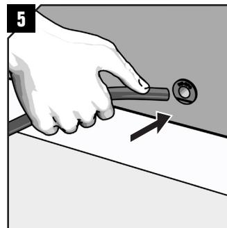
Um Rauchgasdichtigkeit zu gewährleisten, verfügt die B15-SPC Kabeldurchführung im Inneren über eine Membrane, die zur vereinfachten Kabelmontage mit geeignetem Werkzeug vor dem Kabelzug durchstoßen wird. Dieses kann in der Wand (4a) oder vor der Montage (4b) erfolgen.
