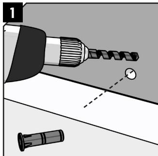
Für Kabeldurchführung B15-SPC senkrechtes Loch mit Durchmesser 15,5mm herstellen, ggf. Schnittgrat entfernen.
